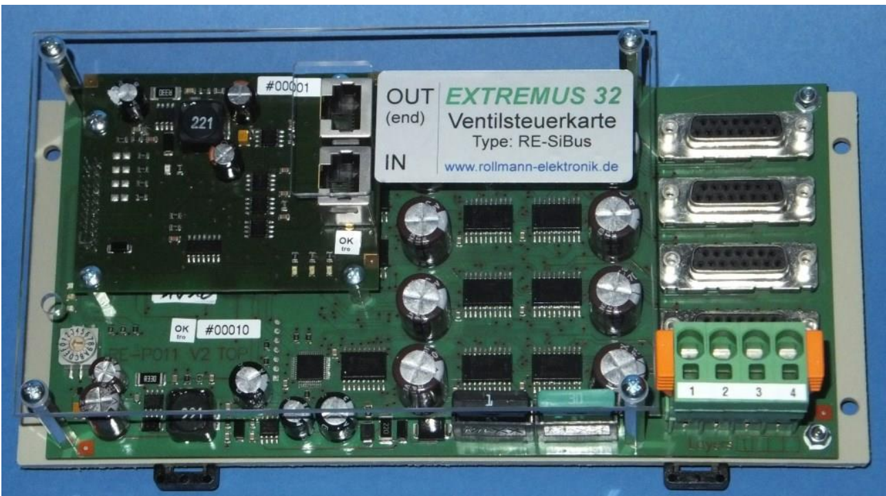
Abbildung mit RE-SiBus-Interface zur Erweiterung von Modbus/TCP oder anderen Businterfaces (Profibus, ProfiNET...)
